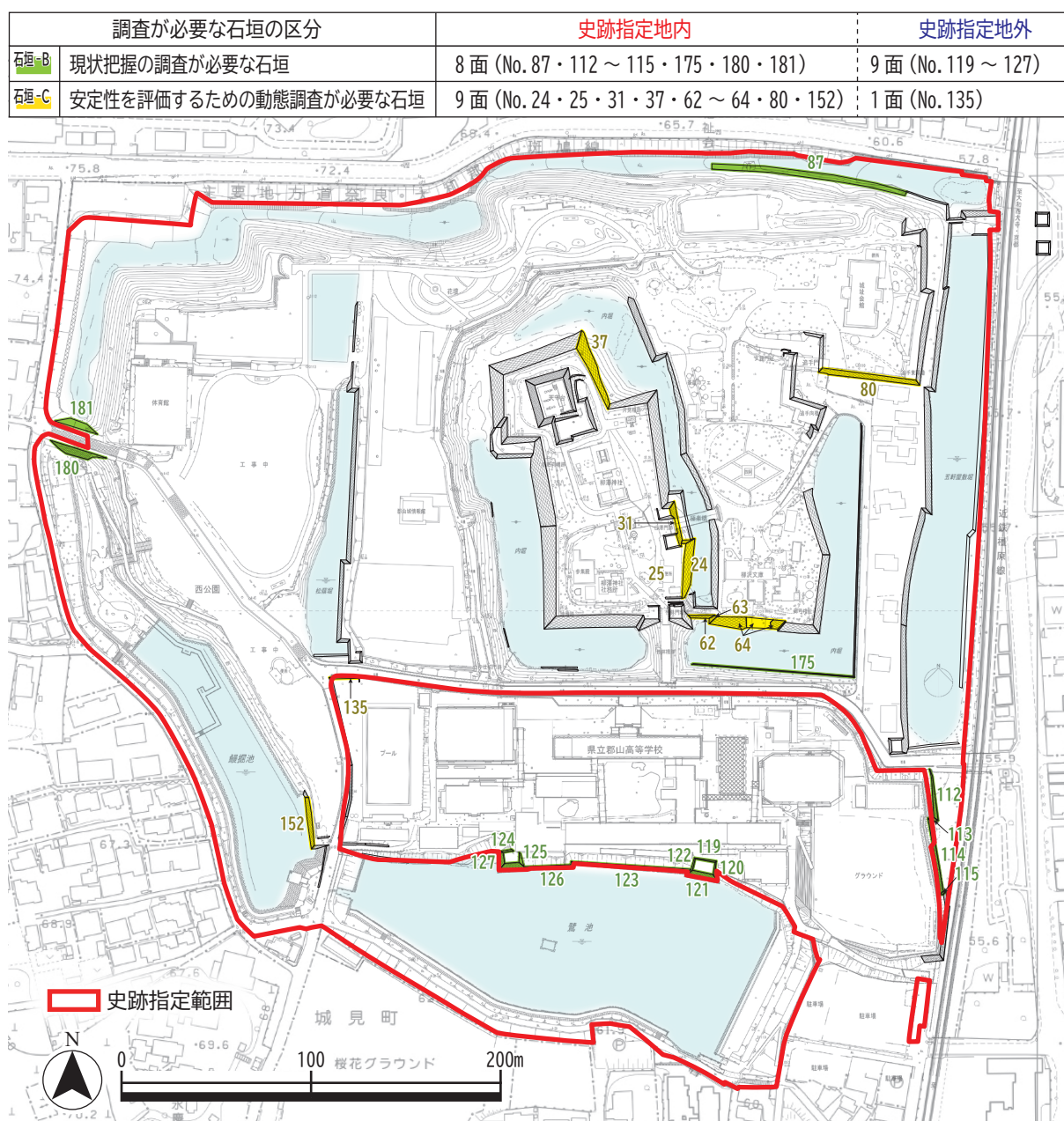
図 5-5 現況調査が必要な石垣
