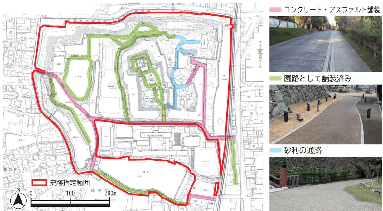
図 10-1 史跡指定地内の動線と舗装の仕上げ (S=1/6,000)
