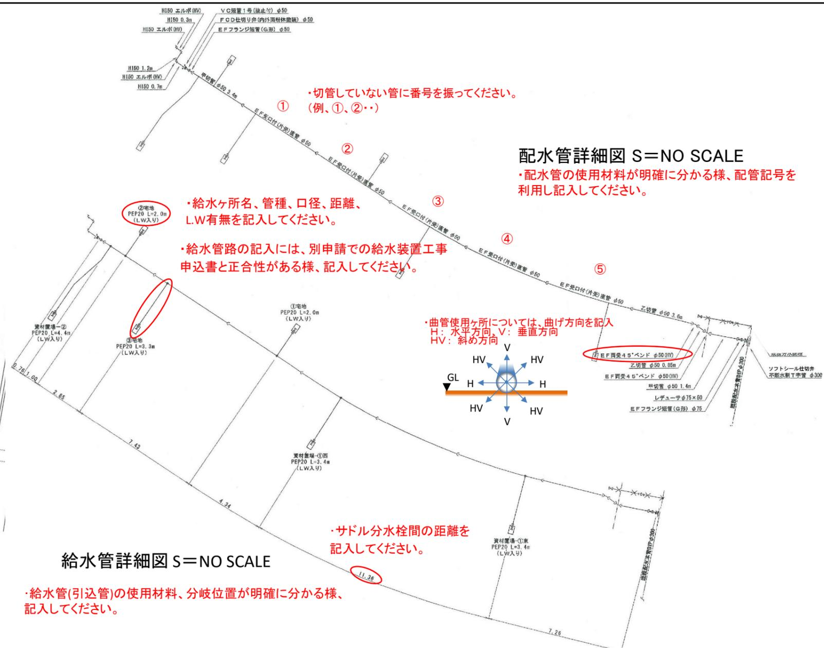
給水管詳細図 S=NO SCALE
